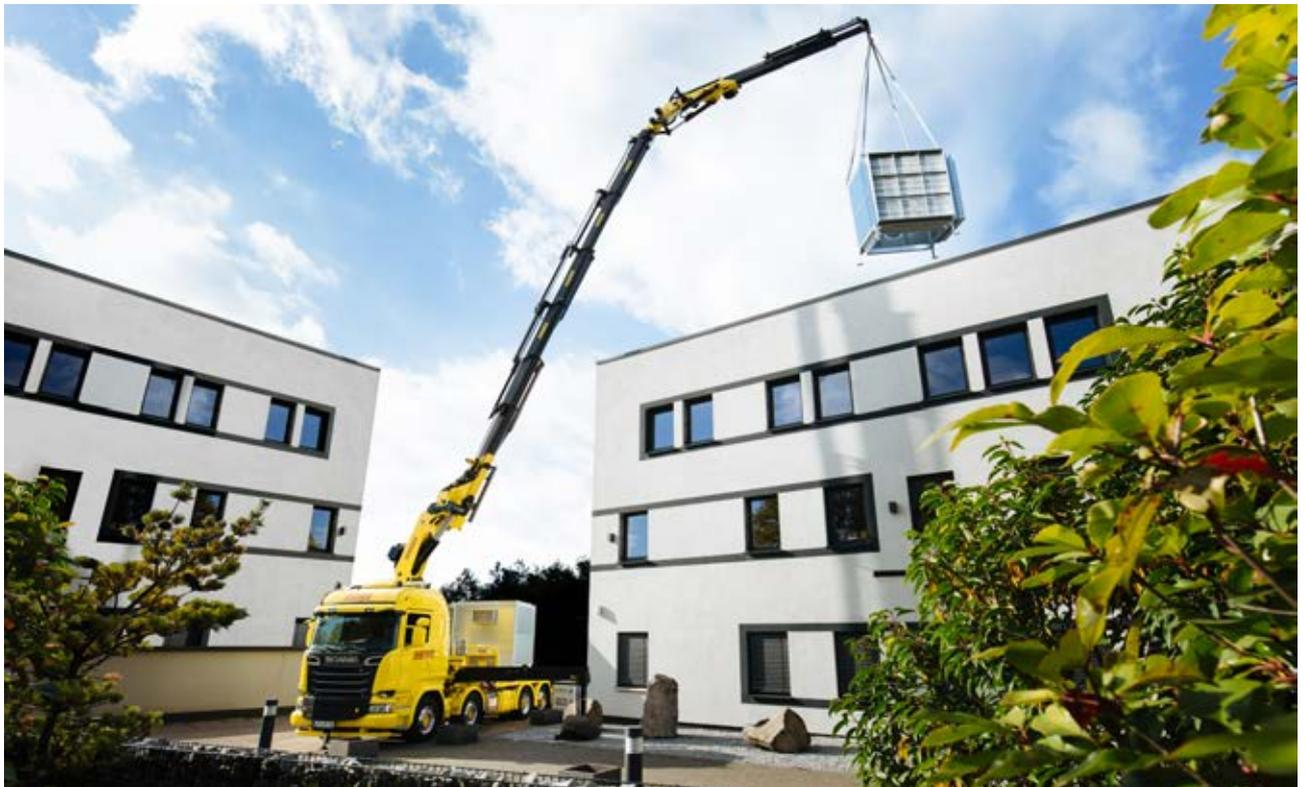
**Leverkusen** – Seit Herbst 2016 ergänzt ein neuer hochmoderner Kran-LKW die vielseitige Flotte des DMS-Logistikers Niesen. Als Spezialanfertigung auf einem Scania-Fahrzeug aufgebaut, erreicht der »Palfinger PK 92002 SH High Performance« Höhen von bis zu 35 Meter bei einer maximalen Nutzlast von 26 Tonnen. Die Einsatzgebiete liegen im Transport von Maschinen, Trafos, Containern oder großen Skulpturen. Der neue Kran übernimmt damit die Aufgaben des früheren Kranfahrzeugs.
